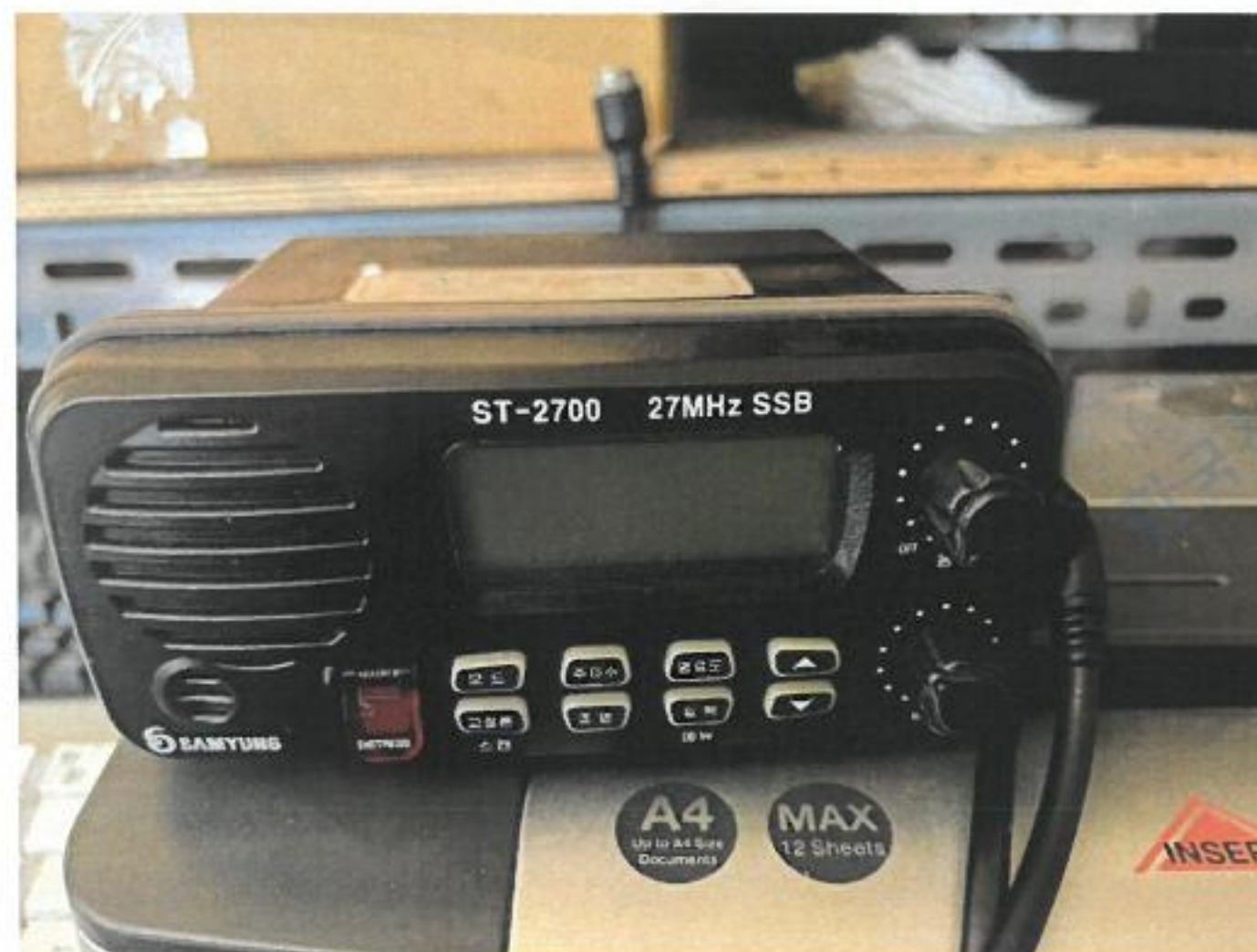
[ 의장품 8)(무전기) 전경 ]
